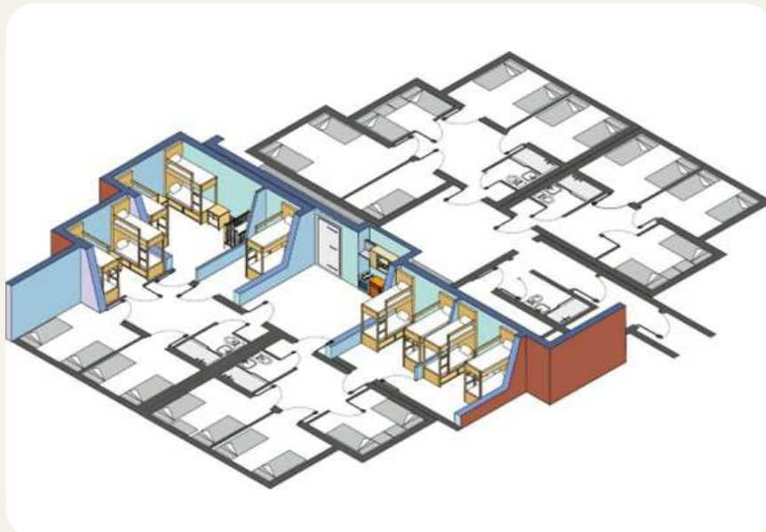
Рисунок 2.7. Схема облаштування укриття в будинку з приватними коморами
