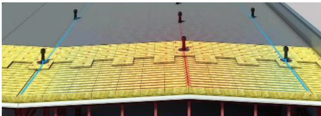
Рисунок. Утеплення суміщеної покрівлі мінераловатними плитами.
