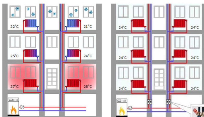
Рис. 4. Опалювальна система до та після балансування
