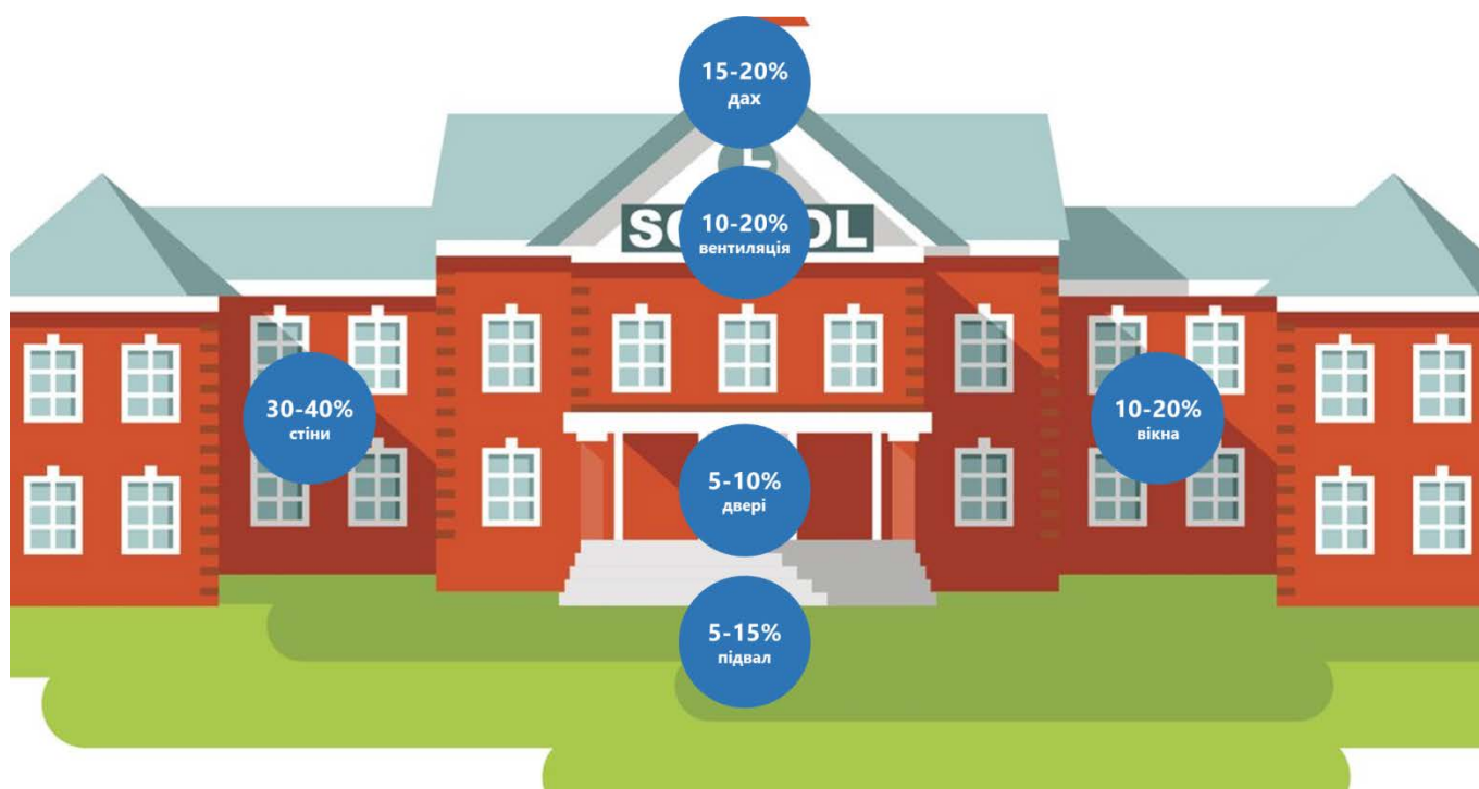
Рис. 3. Орієнтовні значення тепловтрат будівлі
